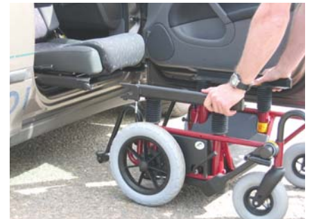
Sgancia la base della carrozzina dalla piastra girevole. Ruota il sedile all'interno dell'abitacolo.
