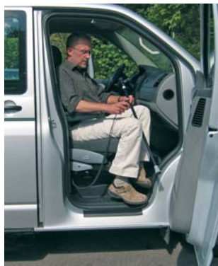
2. Premi il pulsante sulla pulsantiera per ruotare il sedile fino a fuoriuscire dall'abitacolo.
