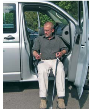
4. Rilascia il pulsante. Il movimento del sedile si arresta
