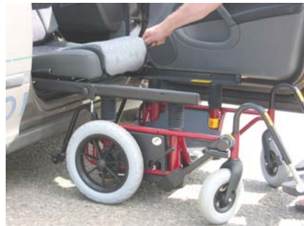
Aggancia la base della carrozzina alla piastra girevole. Spingi il sedile all'interno del veicolo
