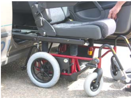
Ruota la piastra installata in auto fino a fuoriuscire dall'abitacolo.
