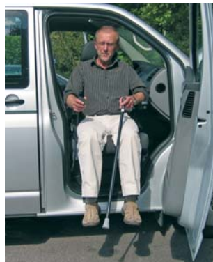
3. Tieni premuto il pulsante mentre il sedile si abbassa fino a raggiungere il livello desiderato
