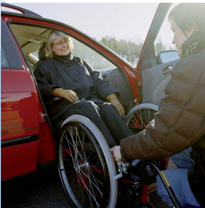
Aggancia la base della carrozzina alla piastra girevole. Spingi il sedile all'interno del veicolo
